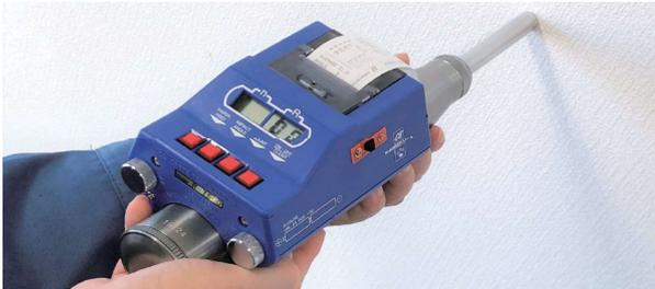
コンクリートテストハンマーは、ばね荷重が与えられた鋼鉄のハンマー(重鎮)をコンクリート面に接触したプランジャーに打撃させ、ハンマーの反発した距離をハンマーと共に、最大値まで移動した指示片の位置を読み取るものです。この指示片位置は、ハンマーの前進移動距離に対する反発距離の割合で読み取り、反発度と呼びます。この反発度がコンクリートの表面硬さを表します。
